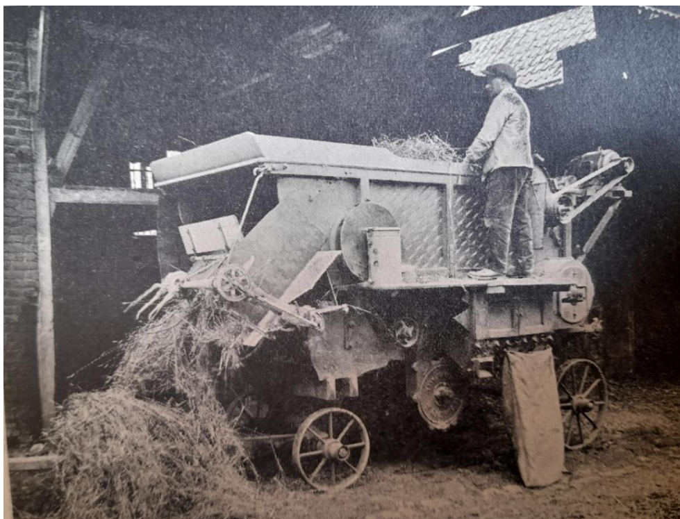
[Exemple de petite batteuse avec entrainement par moteur électrique 6 CV. Source : Applications agricoles et rurales de l'électricité , Eyrolles 1935. Collection Eric Bettega.]
